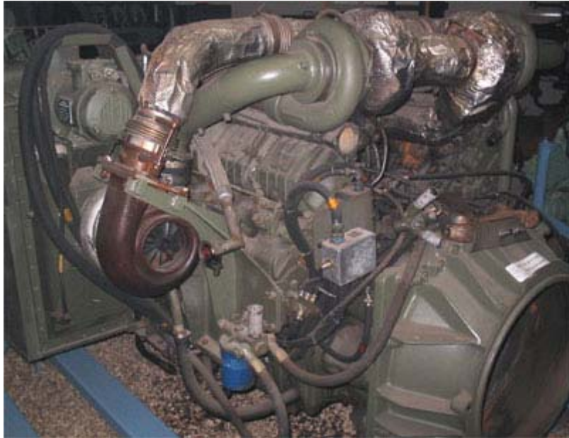
Moteur SSCM pour char AMX 40 exposé au Musée de Saumur (France): 12 cylindres, 970 kW (1300 ch)
